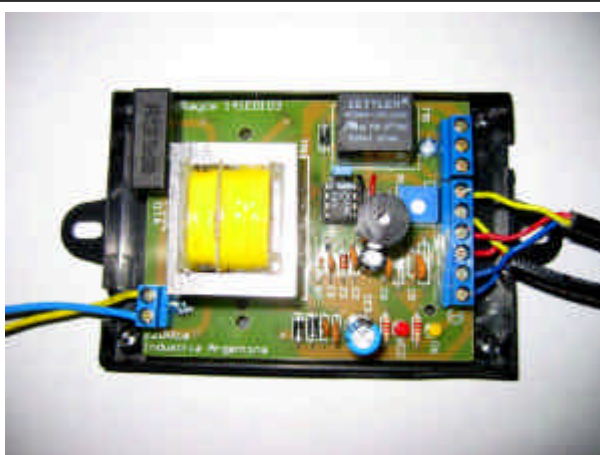
Figura 2: Vista general de la fuente cableada
